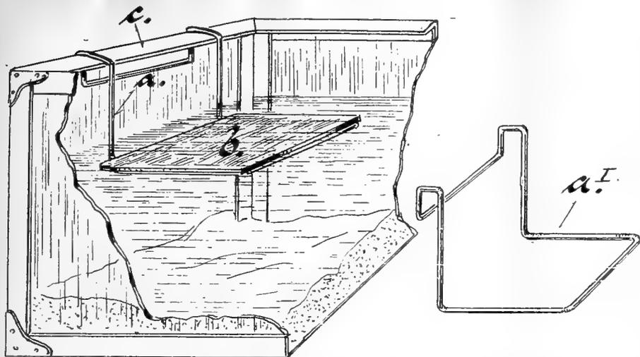
Abb. 4. aI = Bügel aus verzinktem 2,5 mm starkem Eisenraht. a = Bügel auf dem Aquarienrand eingehängt. b = Schieferplatte oder flacher Stein, auf den Bügel aufgelegt,  $\frac{1}{2}$ –1 cm unter Wasser hängend. c = Oberer Aquarienrand.
